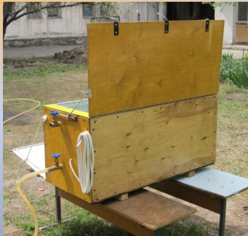
**Самодельный солнечный водонагреватель.** Предназначен для получения горячей воды в весенне-летне-осенний период года.
