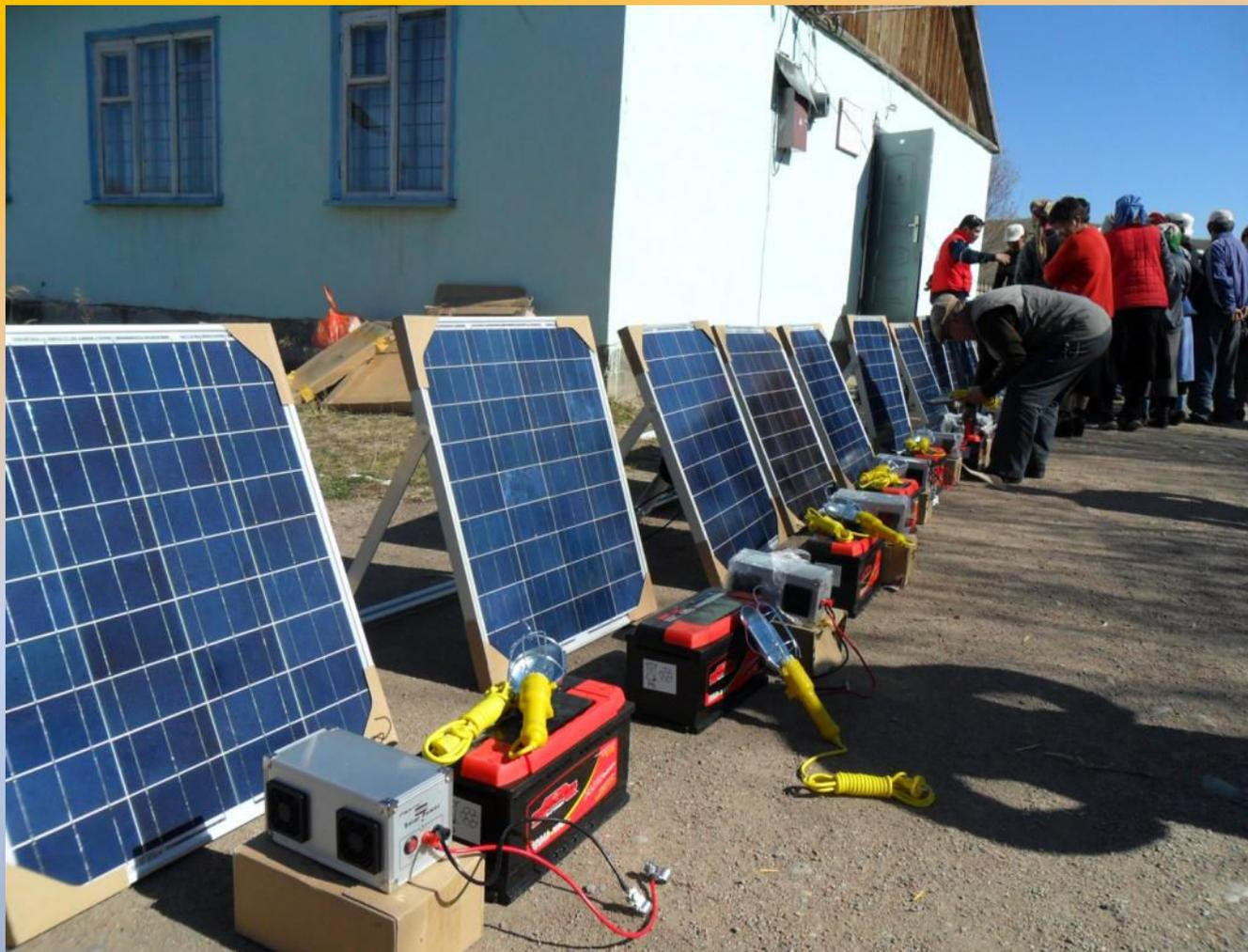
**Компактная фотоэлектрическая станция мощностью 100 Вт.**
