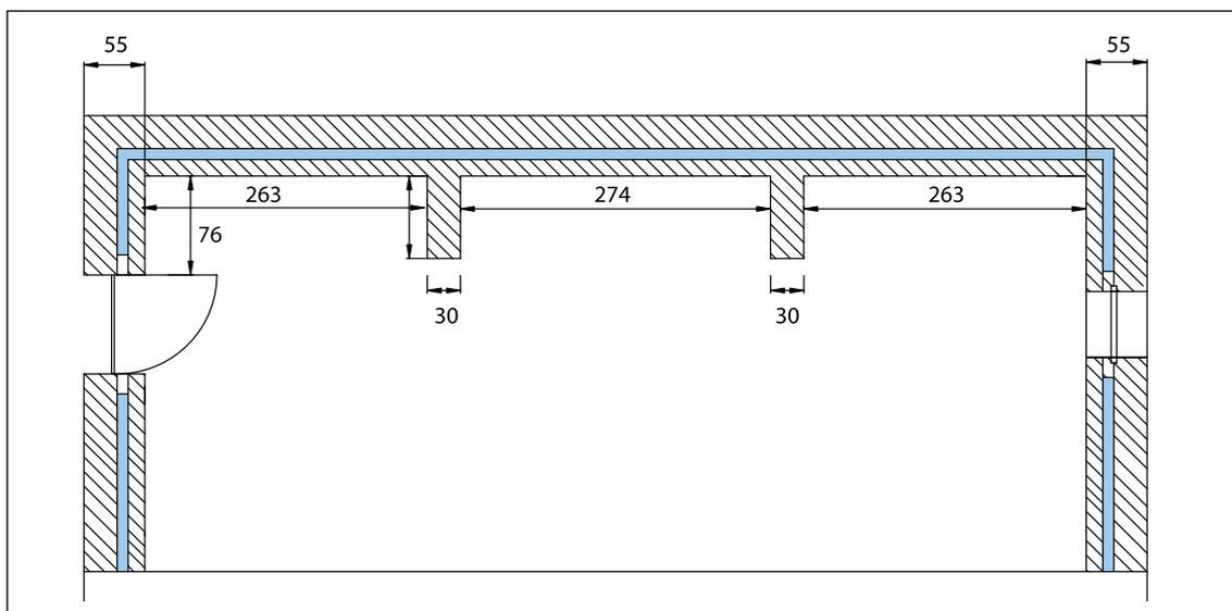
Схема 19 - Вид теплицы с перегородками в плане
