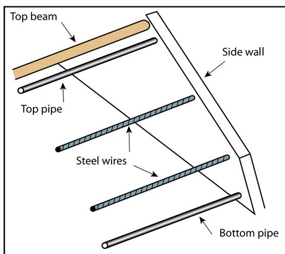
Схема 30 - Конструкция для поддержки дополнительной изоляции
