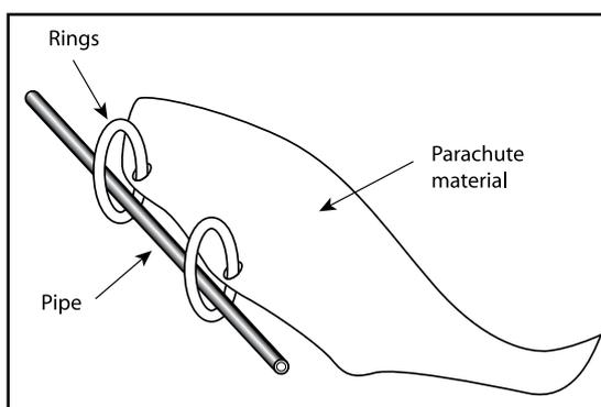
Схема 31 - Крепление ткани к трубе (устройство скольжения)
