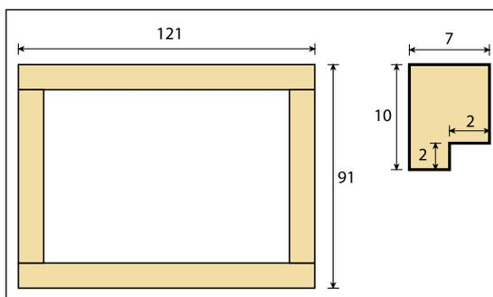
Схема 27 - Подробности изготовления рамы
