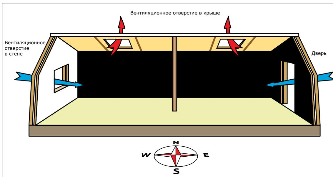
Схема 26 - Циркуляция воздуха через отверстие в крыше
