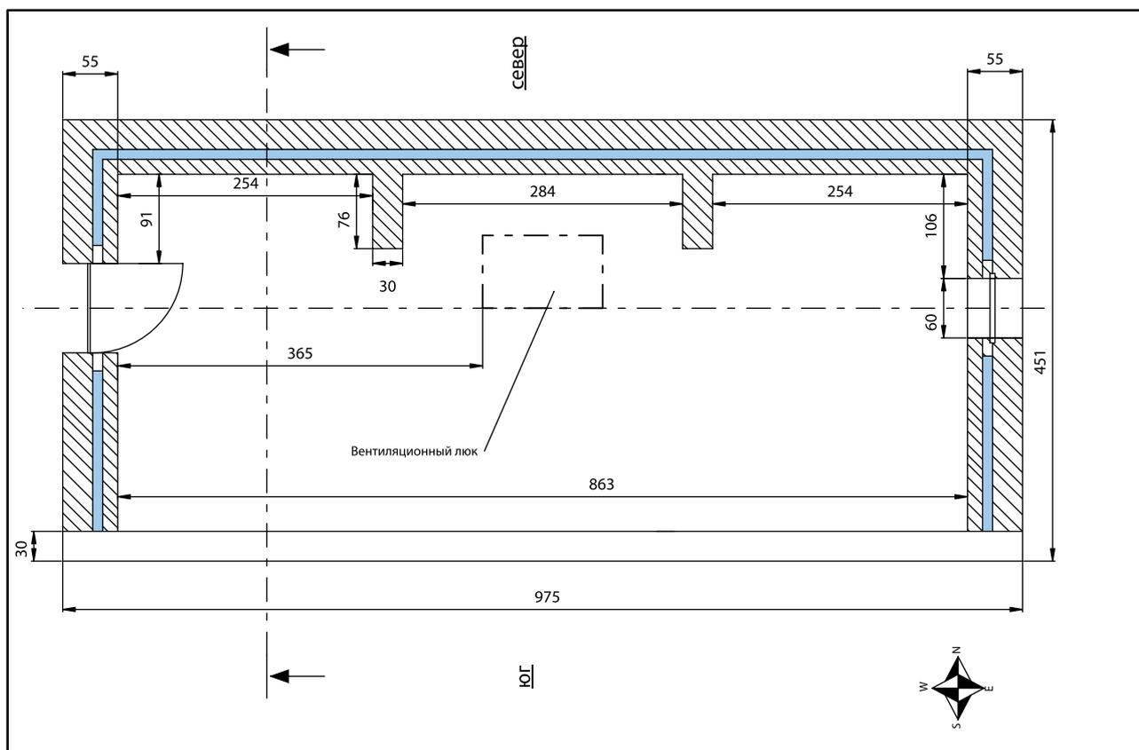
Схема 14 • Конструкция III.В. - Теплица выше 4050 м. Верхний край участка развернут на север
