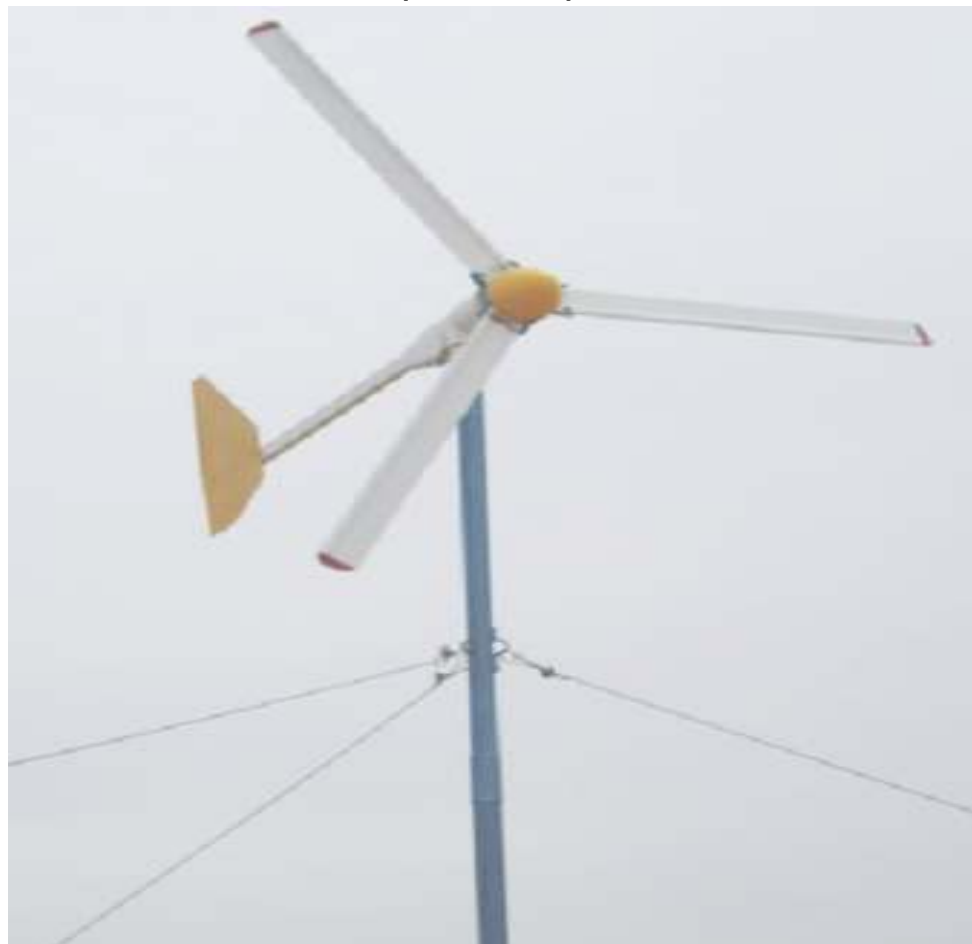
ВЭУ с опорой на растяжках
