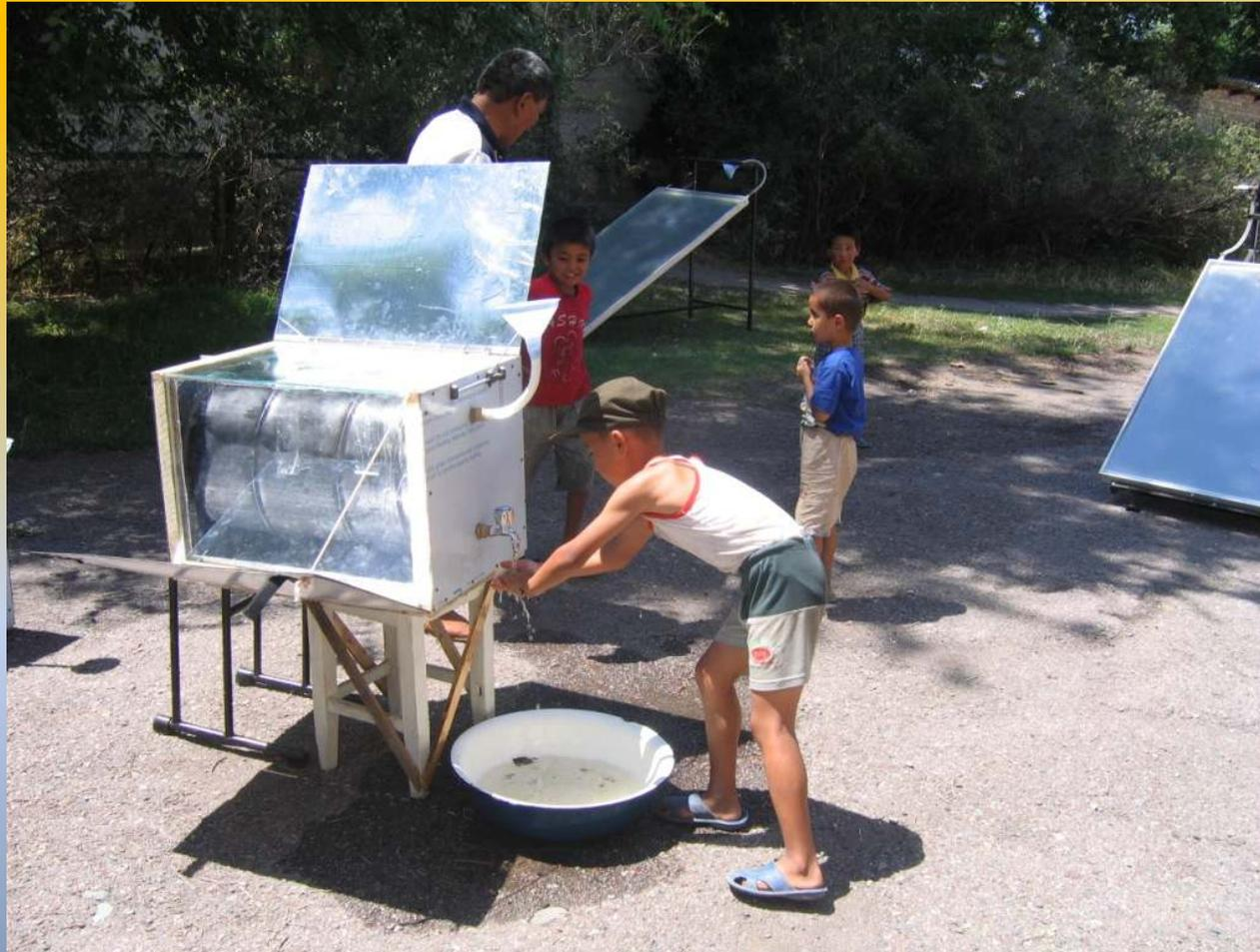
Емкость – 60 л, габариты: 90×50×60 см; летом при ясной погоде нагревает 60 л воды до 60 °С за 4-5 часов, весной и осенью – до 50°С за 5-7 часов.
