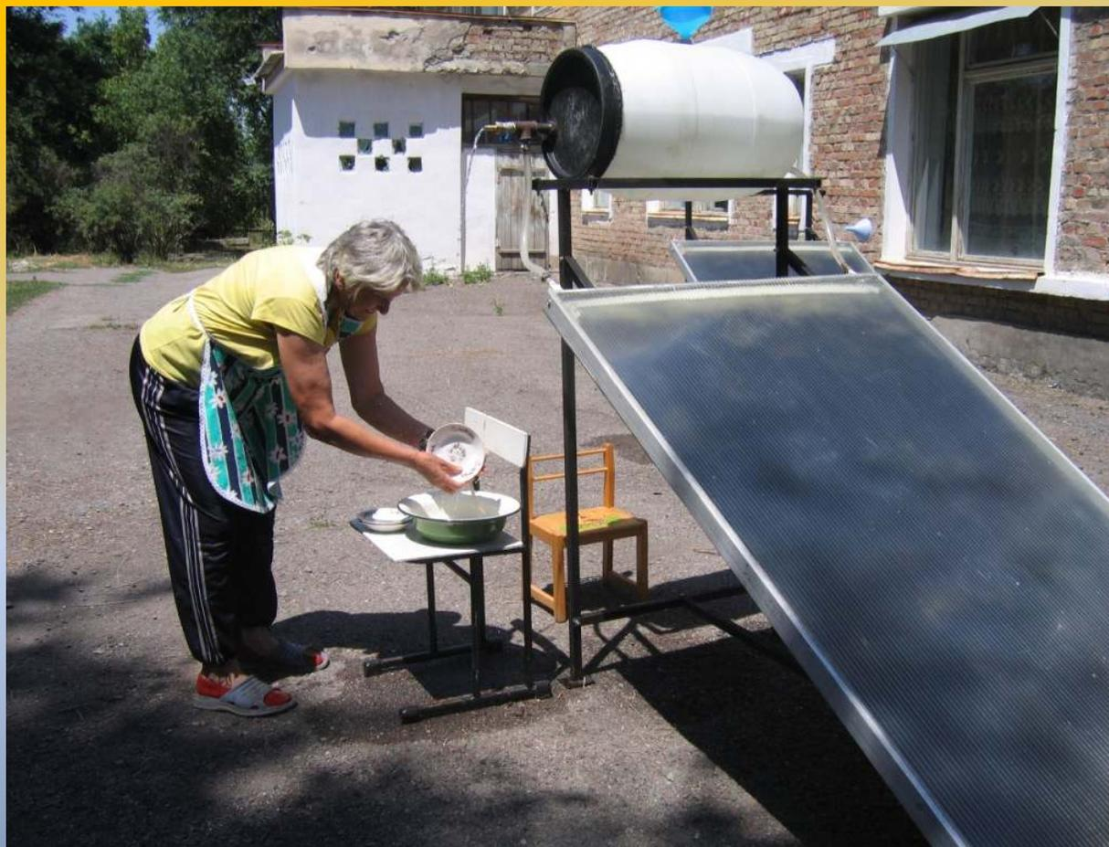
Емкость бака-накопителя – 60 л, габариты: 250×110×250 см; летом при ясной погоде нагревает 60 л воды до 60 °С за 2-2,5 часа, весной и осенью – до 50°С за 3-4 часа.
