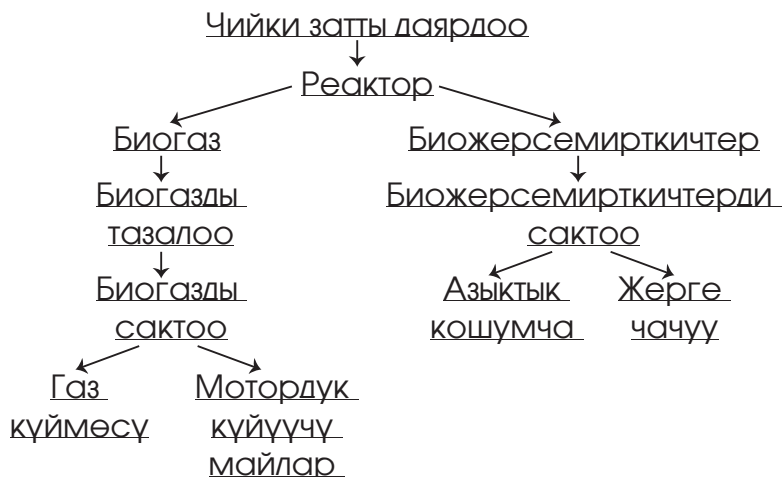
1-сүрөт. Биогаз орнотмолорунда органикалык калдыктарды иштетүү схемасы
