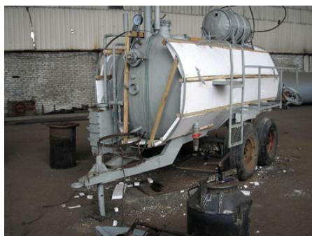
Рис. 12. Биогазовая установка КХ «Байтерек», 5 м 3 Объем реакторов, м 3 – 5, пропускная способность по навозу – 0,3 т/сутки, 100 т/год, производительность по биогазу – 9 м 3 /сутки, 3000 м 3 /год, газгольдер, м 3 – 1
