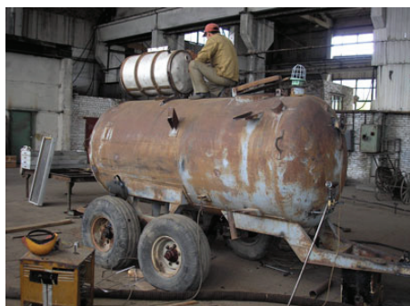
Рис. 12. Биогазовая установка КХ «Байтерек», 5 м 3 Объем реакторов, м 3 – 5, пропускная способность по навозу – 0,3 т/сутки, 100 т/год, производительность по биогазу – 9 м 3 /сутки, 3000 м 3 /год, газгольдер, м 3 – 1
