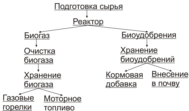
Рис.1. Схема переработки органических отходов на биогазовых установках
