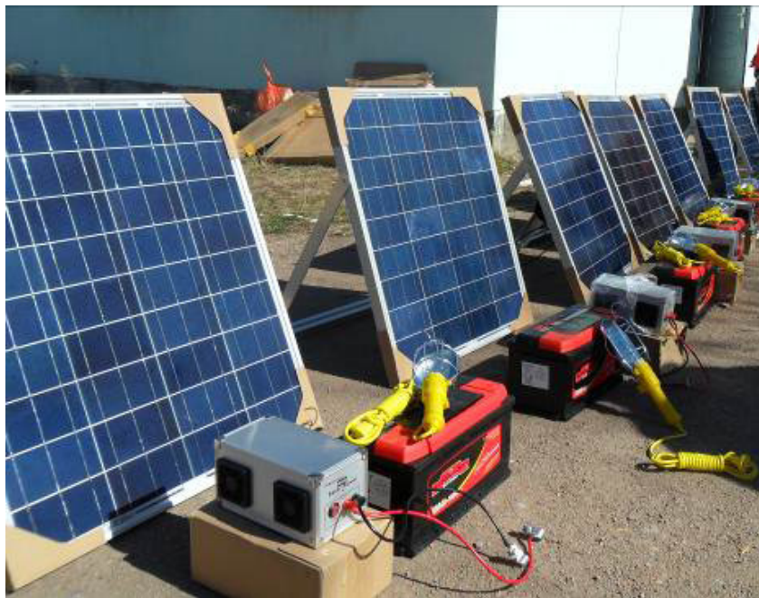
28-сүрөт. 100 Вт кубаттуулуктагы чакан фотоэлектрдик станция.
