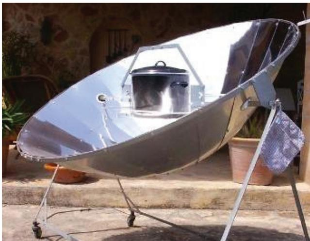
**Рис. 18.** Параболическая солнечная печь для приготовления пищи
