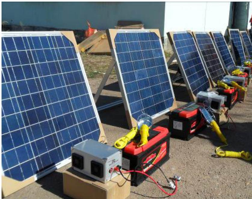
**Рис. 28.** Компактная фотоэлектрическая станция мощностью 100 Вт.
